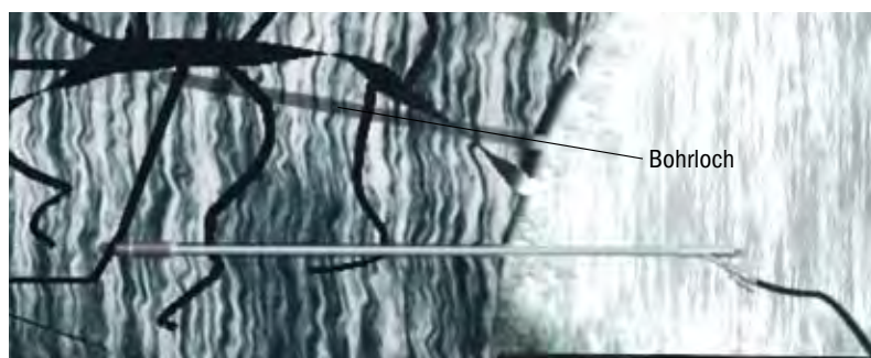
Spannpacker positionieren und mit der Spann- und Injektionsvorrichtung verspannen
