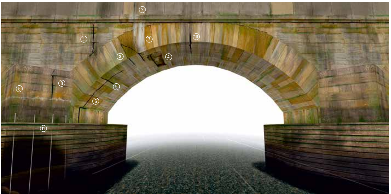
① Riss im Übergang zum Widerlager | Crack in the transition area of the bridge abutment ② Riss in der Brüstung | Crack in the parapet ③ Eckriss | Corner crack ④ Herausfallende Steine | Stones fall out ⑤ Ablösungen | Detachments ⑥ Längsriss | Longitudinal crack ⑦ Ablösung des Bogens | Ring separation ⑧ Risse in der Flügelwand | Cracks in the wing wall ⑨ Kreuzrisse | Crossing cracks ⑩ Scheitelriss | Crack in the summit area ⑪ Bodeninjektion mit Rammverpresslanzen | Ground injection with ram injection lances
