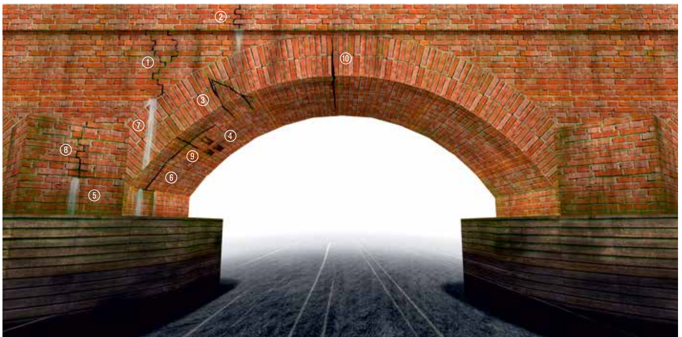
① Riss im Übergang zum Widerlager | Crack in the transition area of the bridge abutment ② Riss in der Brüstung | Crack in the parapet ③ Eckriss | Corner crack ④ Herausfallende Steine | Stones fall out ⑤ Ablösungen | Detachments ⑥ Längsriss | Longitudinal crack ⑦ Ablösung des Bogens | Ring separation ⑧ Risse in der Flügelwand | Cracks in the wing wall ⑨ Kreuzrisse | Crossing cracks ⑩ Scheitelriss | Crack in the summit area ⑪ Bodeninjektion mit Rammverpresslanzen | Ground injection with ram injection lances
