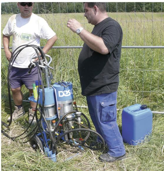
Bild 2: Verpressung des Acrylatgels mit dem Injektionsgerät DESOI PN-1412-3K
