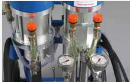
Ölschmierung mit Manometer Lubrication with manometer
