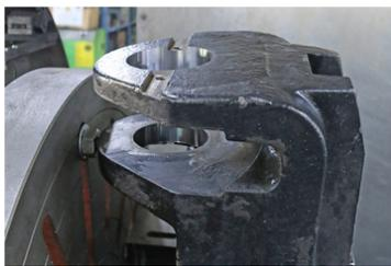
**Reparatur des Mittelgelenks eines Rückezuges**
