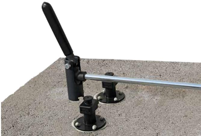
DESOI Z-Slider auf den Flachkopfnippel schieben
