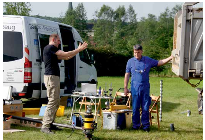
Pfahlprobelastung im Versuchsfeld | Pile load test in the test area
