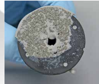
Sehr gute Adhesion auch zwischen Kleber und Packer Very good adhesion also between adhesive and packer
