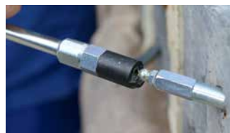
DESOI Snappy auf den Kegelnippel schieben, Sicherungssteg unten | Push the DESOI Snappy onto the round head nipple (locking bar at the bottom)
