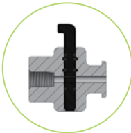
Flachkopfnippel mit Querschieber, freier Durchgang Pan head nipple with shut-off slide, free passage
