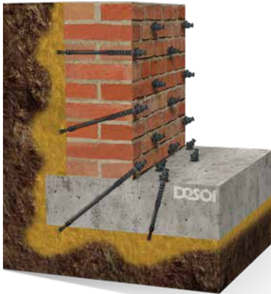
Schleierinjektion | Curtain injection
