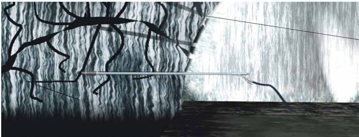
Spannpacker positionieren und mit der Spann- und Injektionsvorrichtung verspannen
