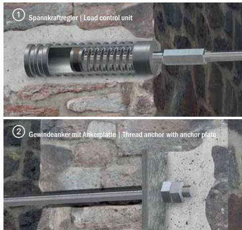
*Detail: Einbau mit Verbundwirkung*
