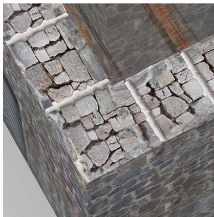
Sicherung gegen dynamische Einwirkungen Securing against dynamic influences
