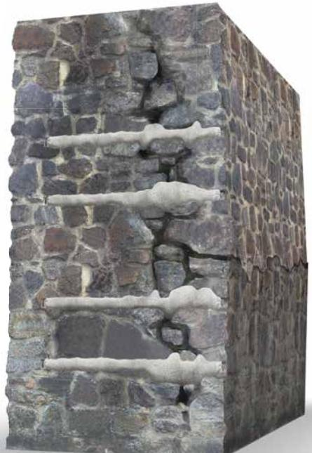
Anbindung abgelöster Mauerwerkschalen
