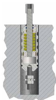
*Prinzipskizze: Spannkraftregler im Bauteil/Bauwerk Einbau mit Verbundwirkung*
