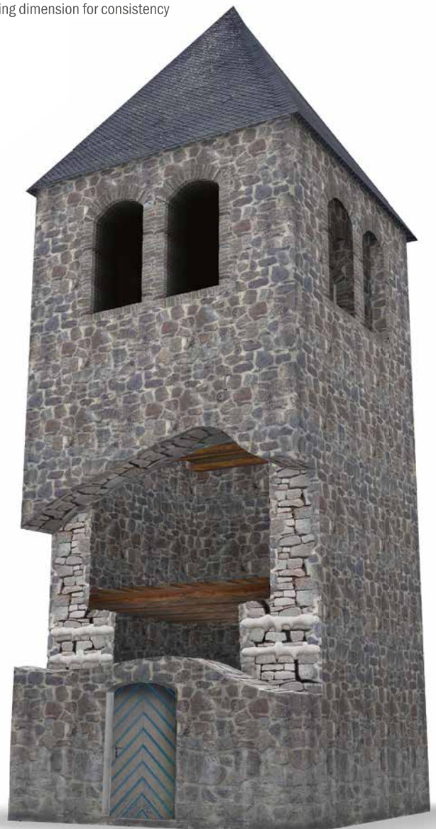
Verbindung abgelöster Mauerwerkschalen Connection of separated wythes
